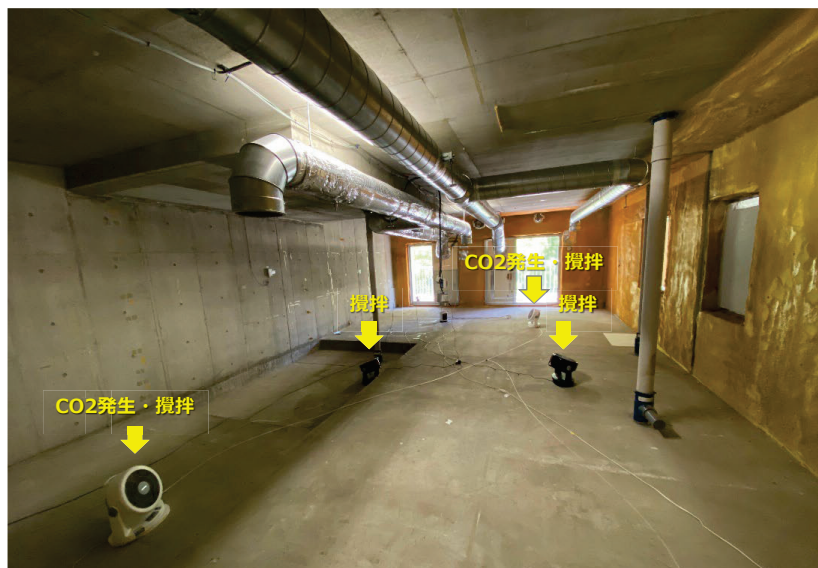
各室のCO2ガスの発生・攪拌の様子
